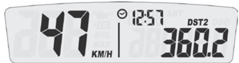
Display 2: Geschwindigkeit, Uhrzeit, DST2
