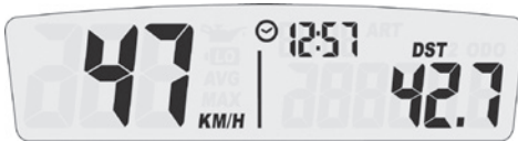
Display 1: Geschwindigkeit, Uhrzeit, DST 1
